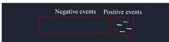
图 2 角速度为 20 (°)/s 的高速暗弱星点目标生成的原始事件
